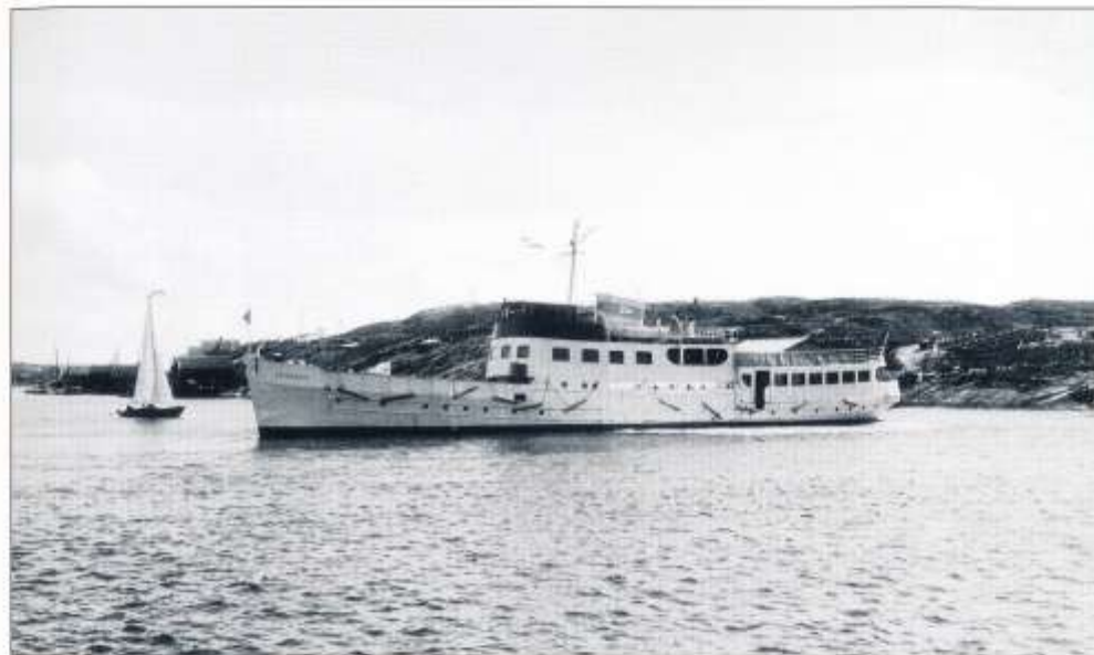
LYSEKIL i Mollösund efter ombyggnaden 1951. Det är inte mycket som påminner om den tidigare ångaren. Matsalen har flyttats till över däck med styrhytten ovanpå. Det tidigare öppna akterdäcket har byggts in. Foto från Walter Nyberg
